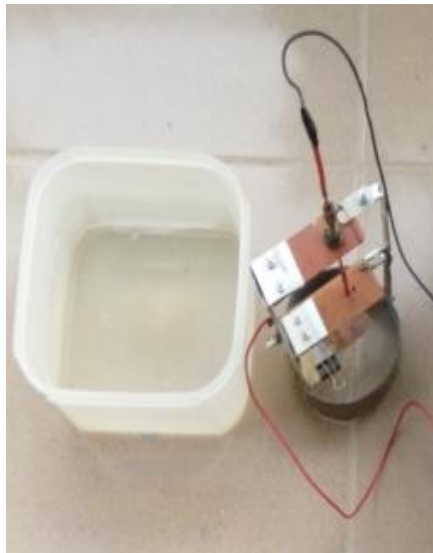
Gambar 2. Bak Penampung dan Tool (Elektroda), Cairan Dielektrik
