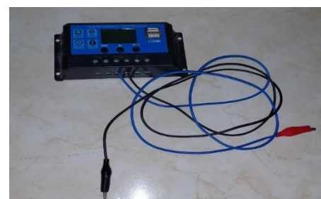
Gambar 3. Pemasangan Kabel ke Solar Charge Controller
