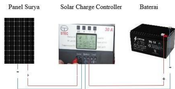
Gambar 6. Skema Rangkaian Panel Surya
