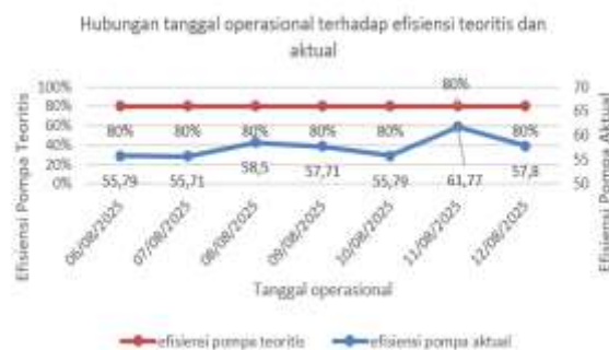
Gambar 8. Grafik Hubungan Tanggal Operasional terhadap Efisiensi Pompa Air Intake Teoritis dan Aktual
