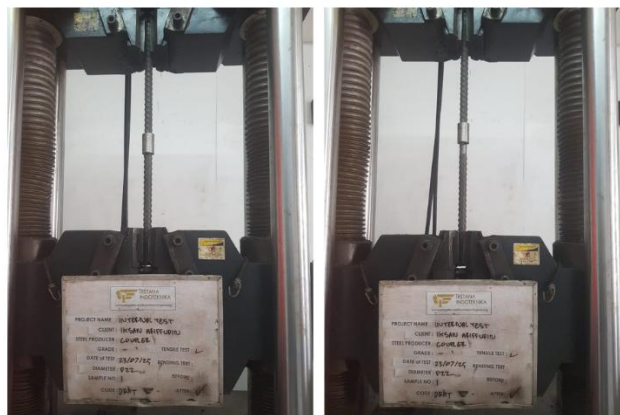
Gambar 2.3 Sebelum dan Sesudah Uji Tarik Sambungan Coupler Ulir
