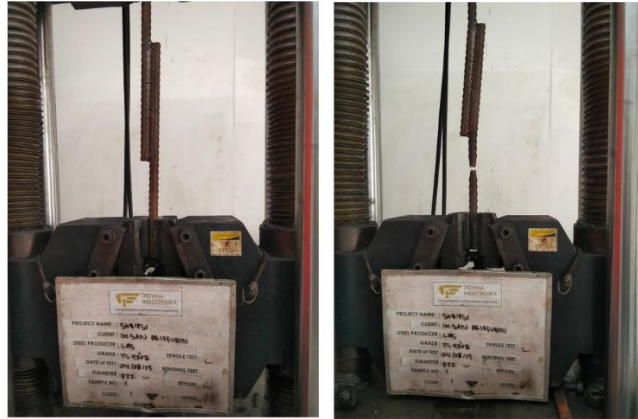
Gambar 2.1 Sebelum dan Sesudah Uji Tarik Sambungan Welding
