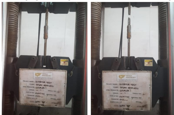
Gambar 2.2 Sebelum dan Sesudah Uji Tarik Sambungan Coupler Press
